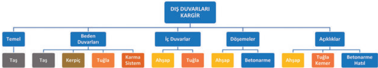
Şekil 26: Dış duvarları kâgır yapılar.
